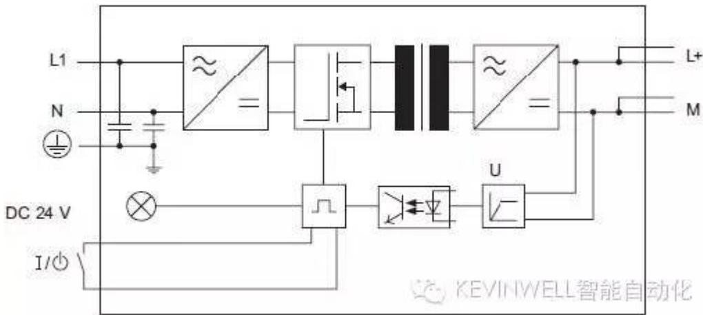
对非典型工作条件的响应:下图为 PS 307; 2.5A 电源模块对非典型工作条件的响应
