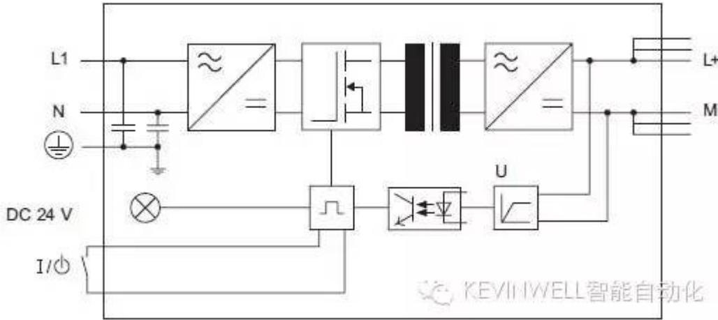
对非典型工作条件的响应:PS 307; 5A 电源模块对非典型工作条件的响应
